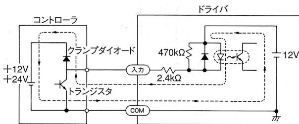
左図のように配線した場合、立ち上げ時にドライバ電源を先にONにしたり、ドライバ電源をON状態のままコントローラ電源をOFFにすると図中矢印のように電流が回り込んで、モータが回ることがあります。
